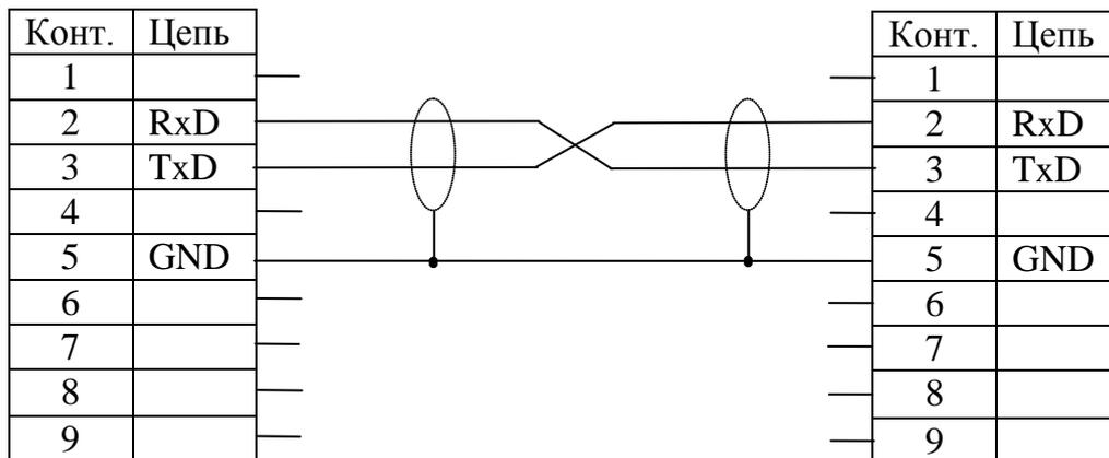
Рис. 9.4 - Схема электрическая кабеля для варианта весов с вилкой DB-9M
