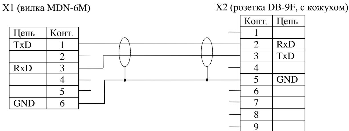
Рис. 9.3 - Схема электрическая кабеля для весов с разъемом MDN-6M
